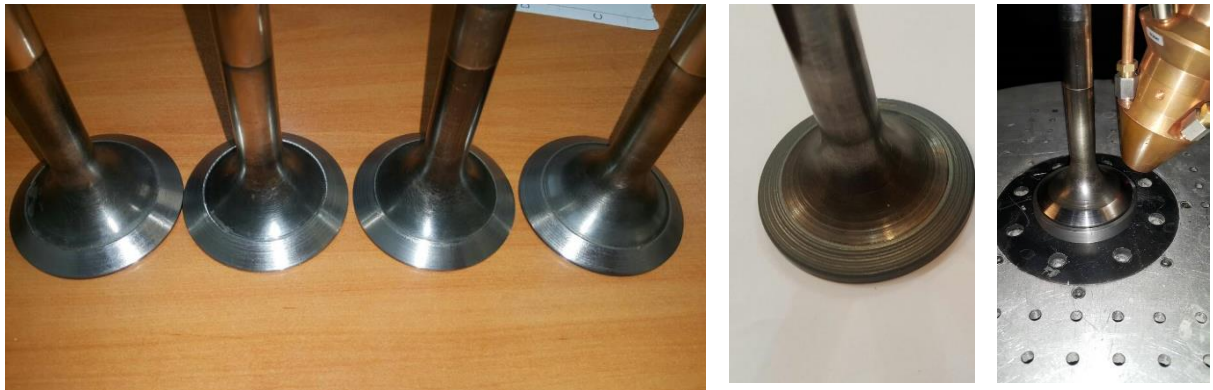
شکل ۵- تصاویر سوپاپ های دود لکوموتیو GM بازسازی شده به روش روکش کاری لیزری
