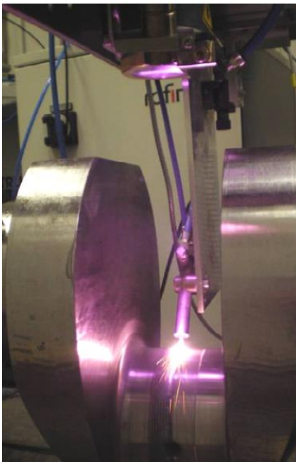
شکل ۳- روکش کاری لیزری یک ژورنال میل لنگ با استلایت ۲۱ [۶].
